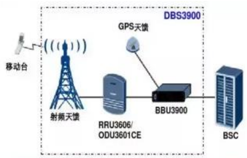
图 39 基站 BBU+RRU 系统示意图
